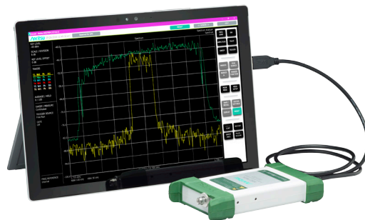
Ультрапортативный анализатор спектра Spectrum Master, подключенный к планшету через USB 3.0.
